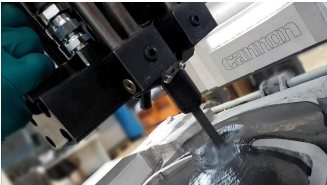
Cannon EG-AX System validiert die wirtschaftliche Verarbeitung von expandierbarem Graphit als Flammenschutzmittel für PU-Schäume. Foto: Cannon Gruppe
